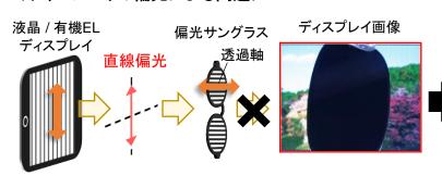
ディスプレイから出射される直線偏光と偏光サングラスの 透過軸が直交する(直交ニコル)状態においては、画面が 全く見えなくなるブラックアウト問題が生じる。 既存の解決策: 4分の1波長板 (λ/4板)
